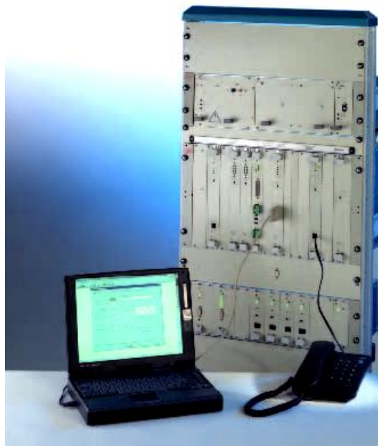
شکل ۱- یک فرستنده/گیرنده ی PLC دیجیتال
